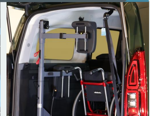
Kopf- und Rückenlehne (links) Bietet zusätzlichen Halt und Komfort für Rollstuhlfahrer.
