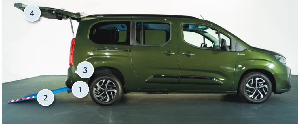
1. Abgesenkter Boden, LED-Beleuchtung und zusätzliches Licht an der Heckklappe
