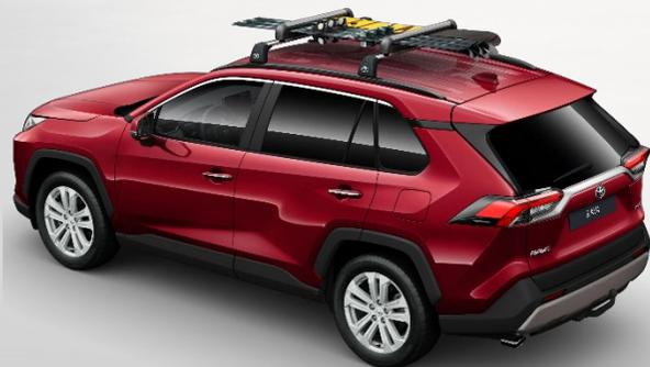
**Dach-Fahrradträger für 1 Fahrrad geeignet**
