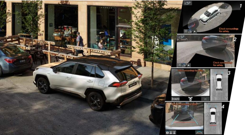
Beim rückwärts Einparken ermöglicht die Rückfahrkamera zentimetergenaues Rangieren.
